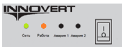
Рис.6 Индикатор «Сеть» о том, что напряжение приходит на плату управления УПП INNOVERT SSD, и индикатор «Работа» о том, что на УПП INNOVERT SSD приходит силовое питание 380В.
